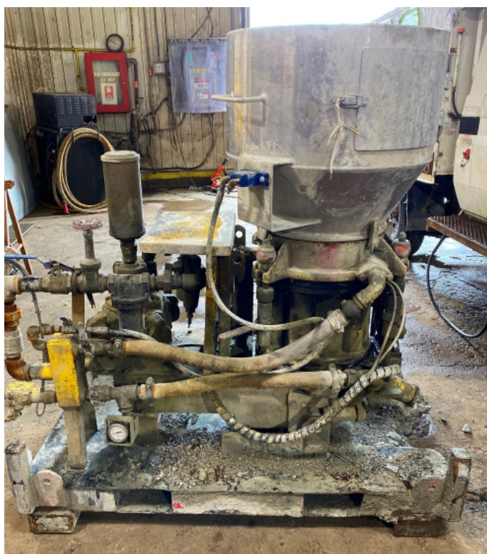
ANTES: Acumulación de hormigón proyectado
